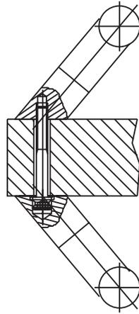
**Befestigung** für schräge Anschluss-Stücke paarweise auf Holztüren. Türstärke und paarweise bei Bestellung angeben.
