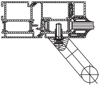
**Standard-Befestigung** für schräge Anschluss-Stücke auf Türen mit M8-Gewinde einschließlich Spezialschraube.
