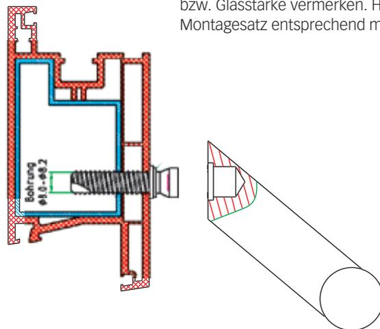
**Sondermontagesatz, gerade**, für einseitige Montage auf Kunststoff- und Aluminiumtüren mit Selbstschneideschraube bei geraden Griffstücken, siehe **Art. 25839** Schraubenset.
