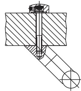
**Befestigung** für schräge Anschluss-Stücke einseitig auf Holztüren mit Spezialschraube und Abdeckkappe **26058 VAP** (bitte separat bestellen).
