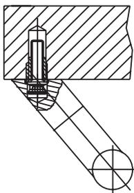
**Befestigung** für schräge Anschluss-Stücke auf Holztüren mit RAMPA-Mutter **25 846** (bitte separat bestellen).
