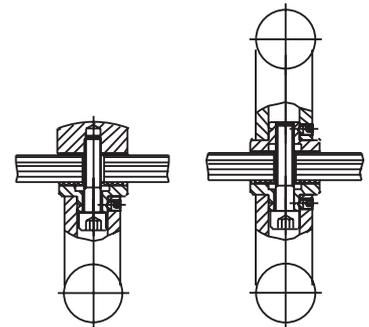
**Befestigung auf Glastür** für gerade Anschluss-Stücke – einseitige Befestigung mit Befestigungsstück Art. 26057 VAP. Bei paarweiser Montage auf der Bestellung Tür- bzw. Glasstärke vermerken. Hier wird der Montagesatz entsprechend mitgeliefert.
