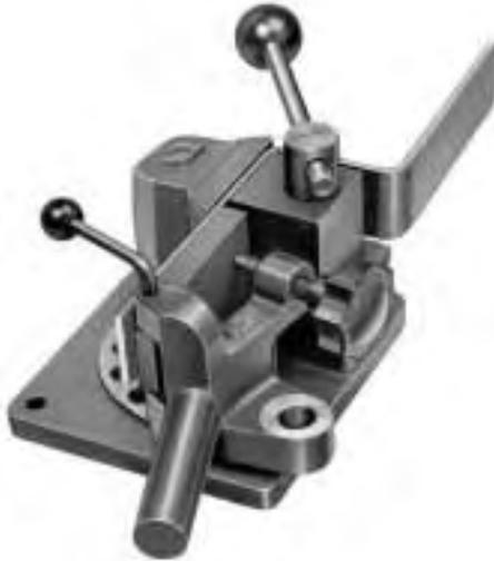
Der Winkelbieger **GWB 70** hat eine Arbeitshöhe von 70 mm. Mit ihm kann beispielsweise Flacheisen bis zu 70x8 mm kalt oder 70x20 mm warm gebogen werden.
