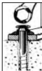
Die Sicherheits-schrauben für Fenstergitter, Kellerroste, Lampen und ähnliches sind formschön und sicher. Ein Kopfabbohren ist nicht erforderlich.
