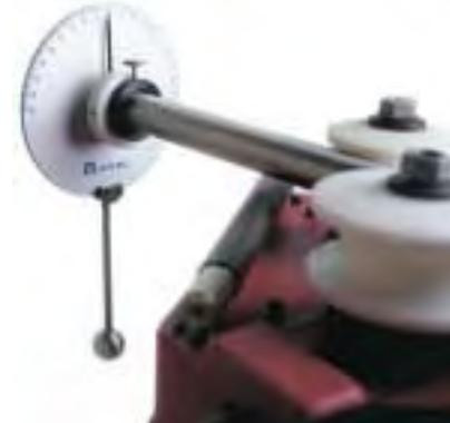
Mechanisches Meßgerät in solider Ausführung, zum Messen der Verdrehung beim Wendelwalzen. Adapter für 1 1/4" Rohr.
