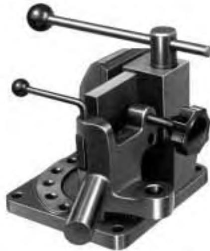
Der Winkelbieger **GWB 100** hat eine Arbeitshöhe von 100 mm. Mit ihm kann beispielsweise Flacheisen bis zu 100x8 mm kalt oder 100x20 mm warm gebogen werden.
