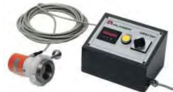
Digitale Auswertelektronik mit Pendeldrehgeber zum Messen der Verdrehung beim Wendelwalzen. Anschluß 220V, Kabellänge 7 m.
