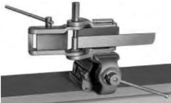
Mit dem Bandroller und Ösenbieger GOB 100 können Ösen aus Vierkant- und Rundeisen kalt oder warm gebogen werden. Der Arbeitsbereich beträgt max. 100 mm. Der Ösendurchmesser kann durch leicht auswechselbare Biegedorne standardmäßig zwischen 10 und 30 mm gewählt werden.
