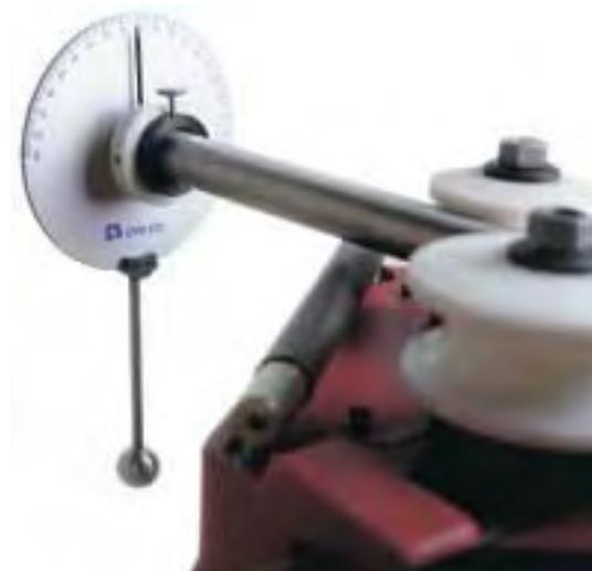
Mechanisches Meßgerät in solider Ausführung, zum Messen der Verdrehung beim Wendelwalzen. Adapter für 1¼" Rohr.
