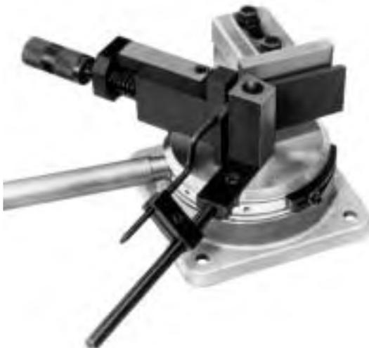
Der Winkelbieger **GWB 20** hat eine Arbeitshöhe von 100 mm. Mit ihm kann Flacheisen bis zu 100x7 mm kalt und 100x15 mm warm gebogen werden. Der Biegebereich ist auf einer ablesbaren Skala bis max. 180° einstellbar.
