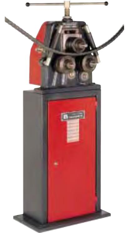
Die Bogen- und Ringbiegemaschine GEBR 602 wird manuell betrieben und zeichnet sich durch eine robuste Bauweise aus. Sie hat zwei feststehende Antriebsbiegewellen und eine zustellbare, freilaufende Druckwelle. Die Biegewellen haben einen Durchmesser von 30 mm. Durch den kleinen Abstand der feststehenden Biegewellen können sehr kleine Radien gebogen werden.
